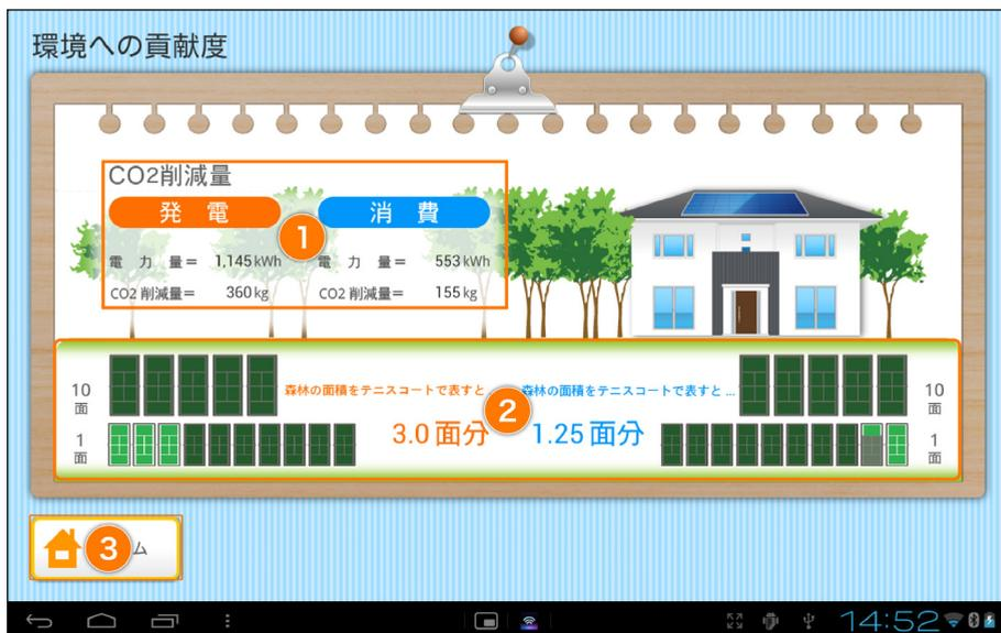
①CO2 削減量 発電電力量と消費電力量を CO2 換算して表示します。
