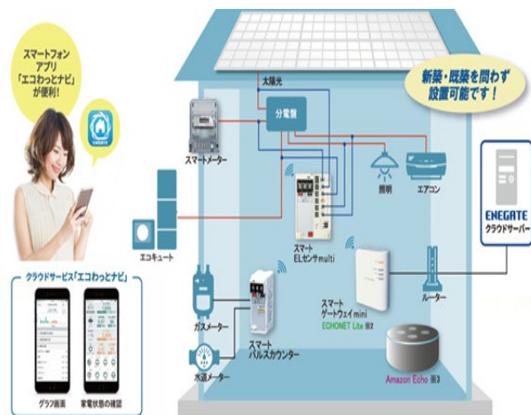
家庭用のエネルギー管理システム
